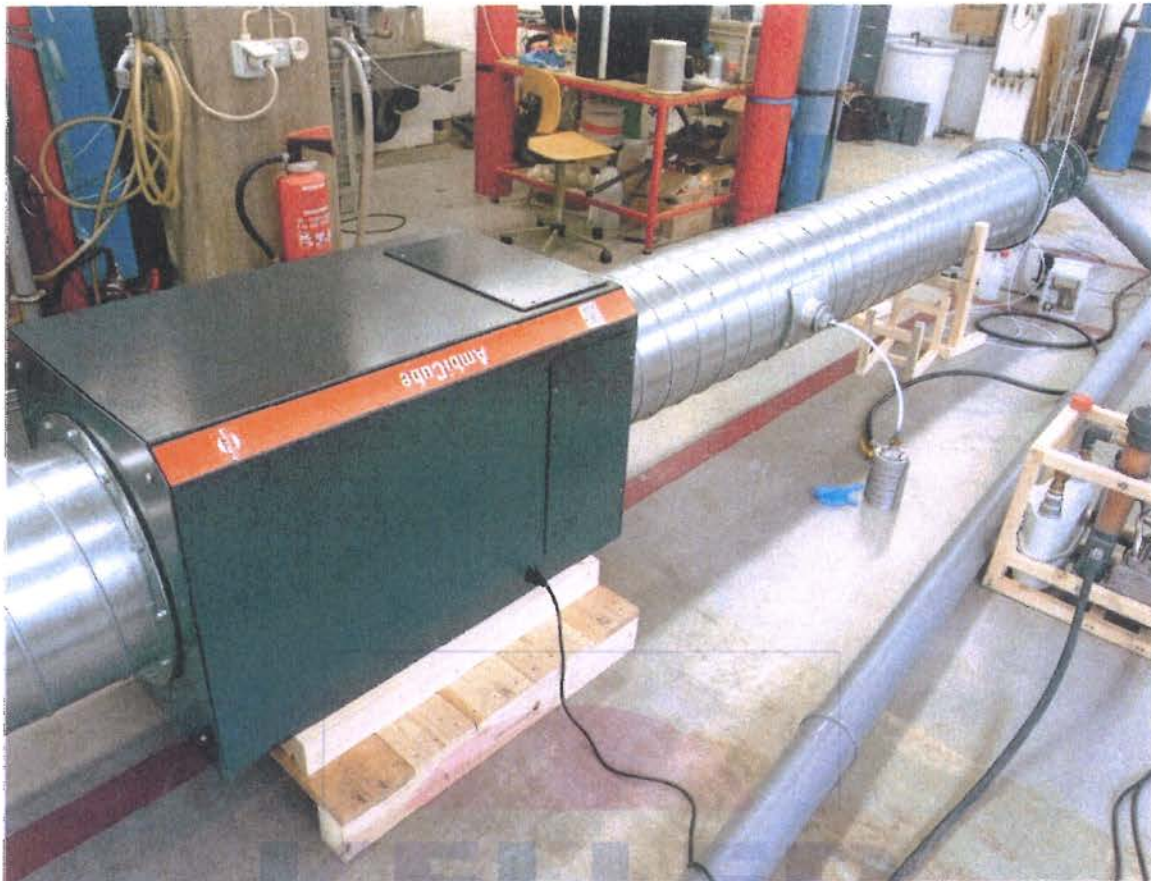
Abb. 2: Probennahmestelle mit Andersen-Kassadenimpaktor und nachgeschalteter Pumpenmimik für Bereitstellung eines gerätespezifischen Luftvolumenstroms von 28,3 NL/min.
